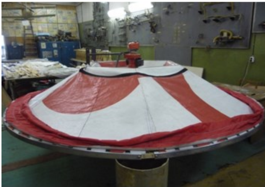
Окончательная сборка подушки
