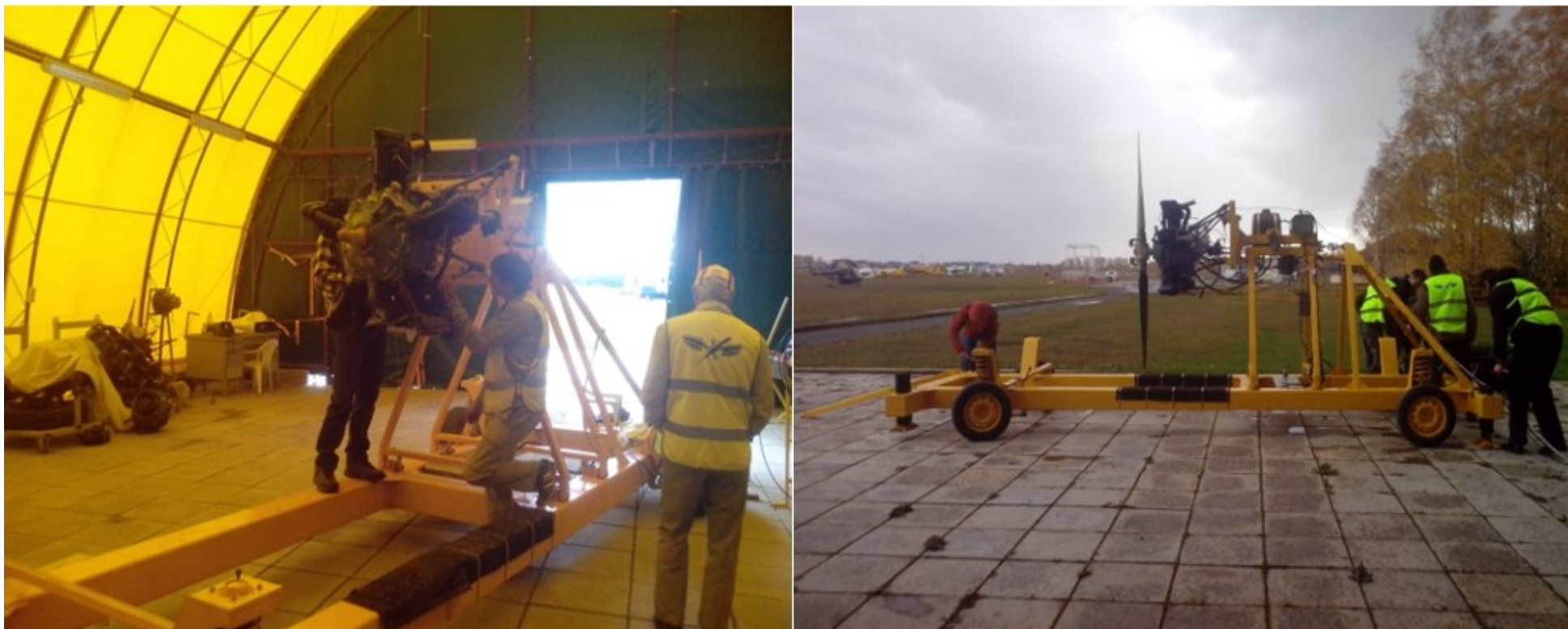
Подготовка к испытаниям авиационного двигателя М-11ФР на испытательном стенде
