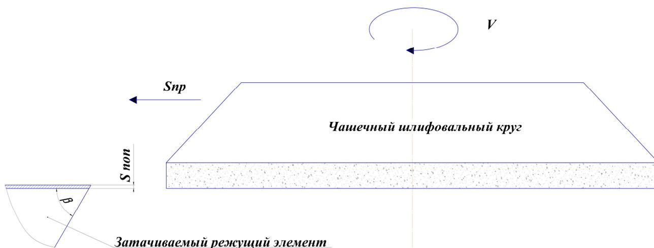
Рисунок 3.23. Схема затачивания режущего элемента
