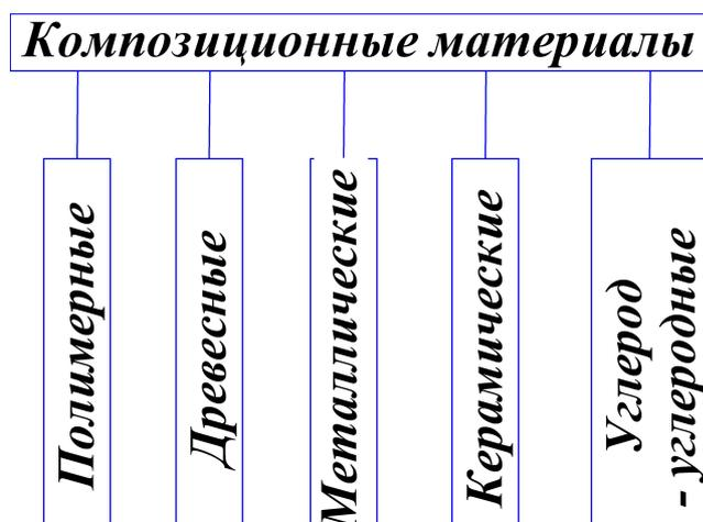
Рисунок 1.1. Классификация композиционных материалов по типам матриц
