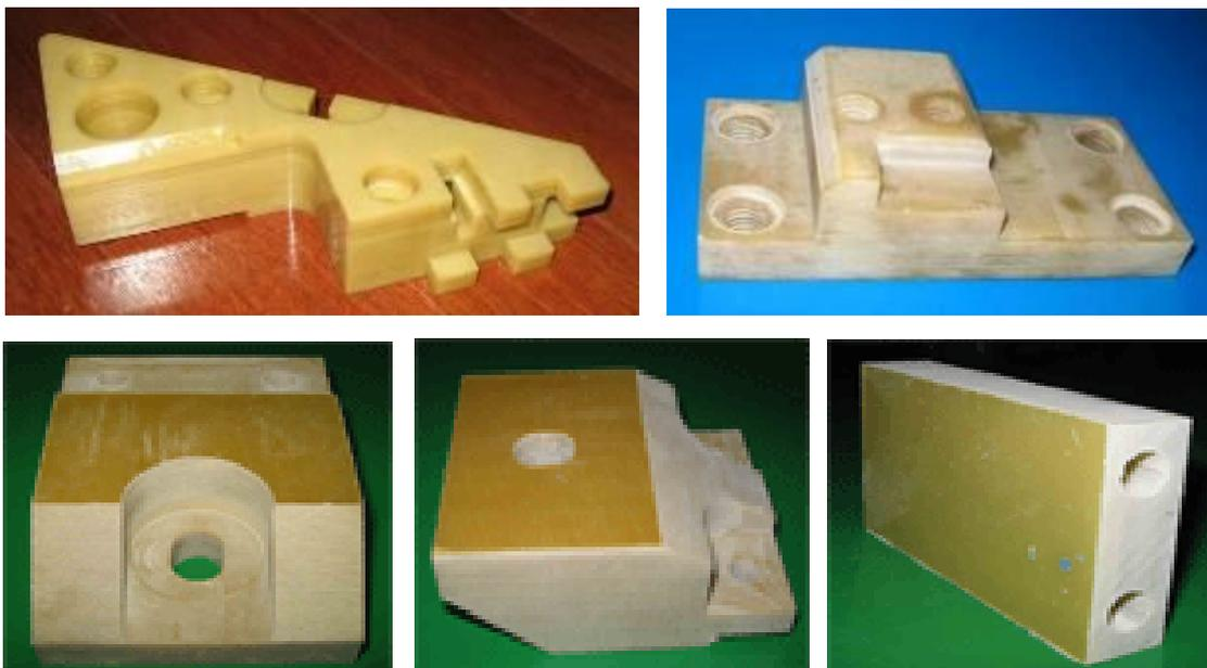
Рисунок 1.2. Примеры изделий, полученных механической обработкой заготовок из композиционных неметаллических материалов
