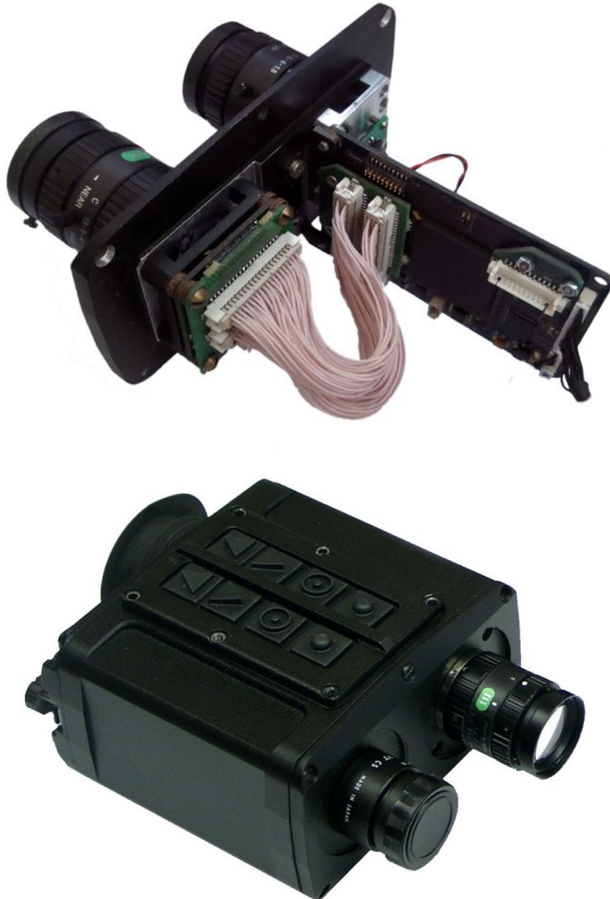
Рисунок 22 – Внешний вид прибора-стенда (сверху – без защитного кожуха, снизу – в защитном кожухе)
