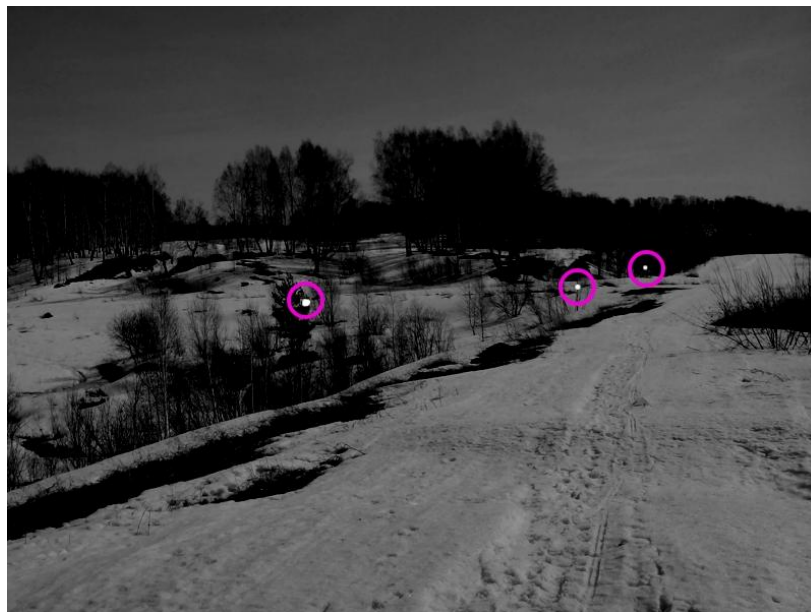
Рисунок 45 – Наблюдение бликов от катафотов, расположенных на расстояниях 100 м (левый), 170 м и 200 м (правые)
