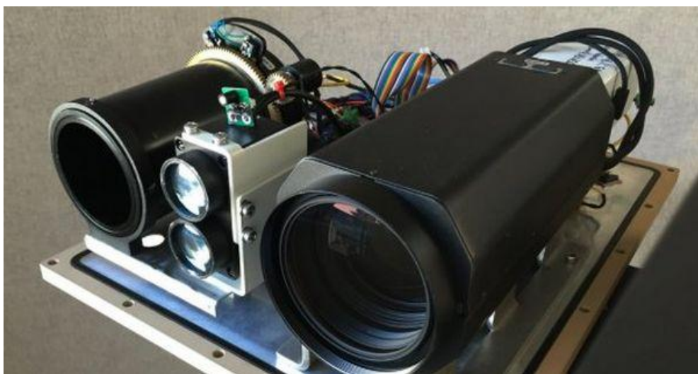
Рисунок 3 – а) внутренний вид отечественного активно-импульсного прибора на основе ЭОП. б) прибор разработки Infiniti Electro-Optics (Канада)
