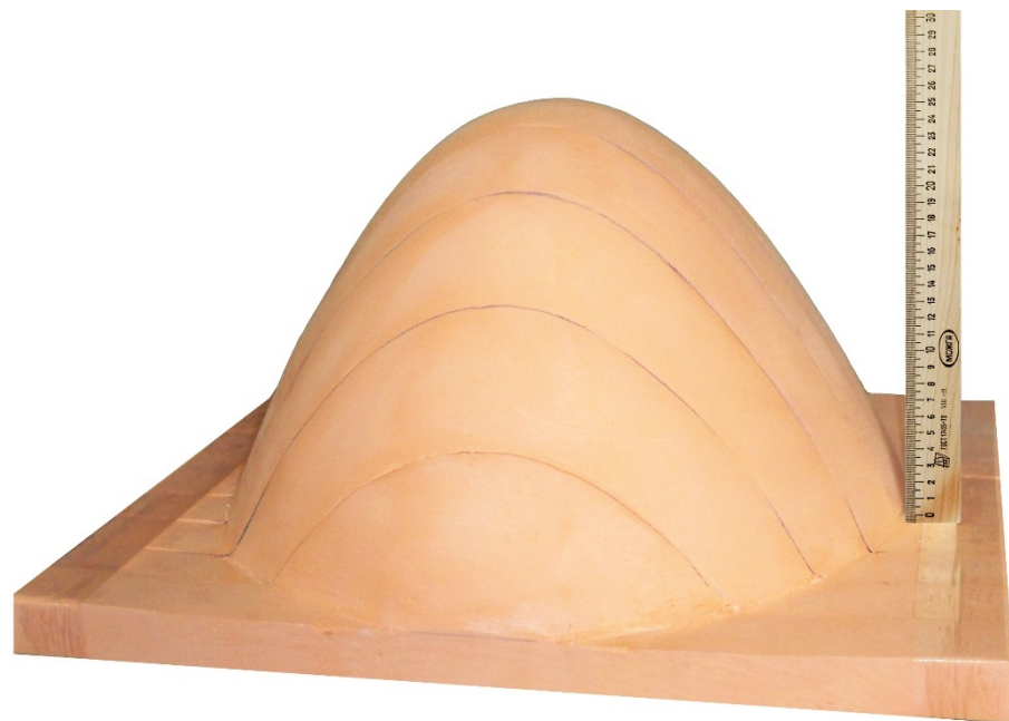
Рисунок 4.6 – Радиолинза диаметром 0.5 метра из экструдированного пенополистирола
