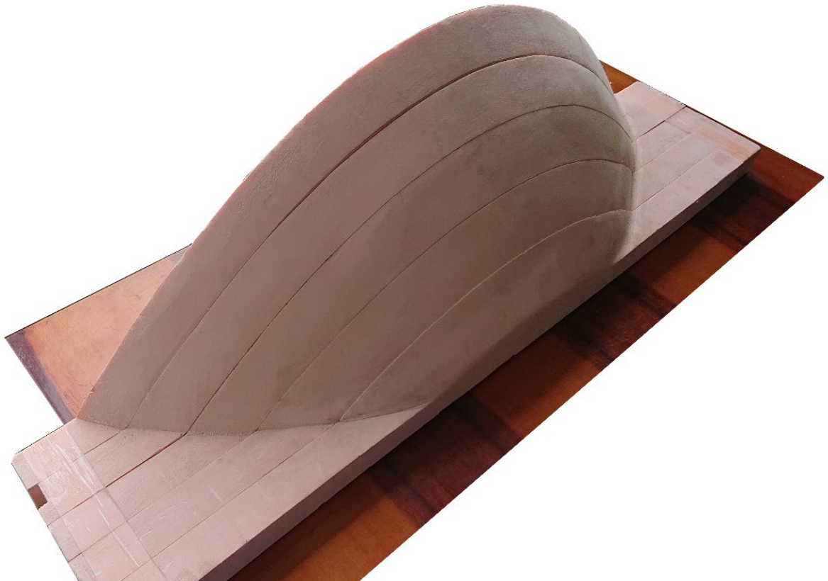
Рисунок 4.4 – Фрагмент радиолинзы, изготовленный из листов диэлектрика
