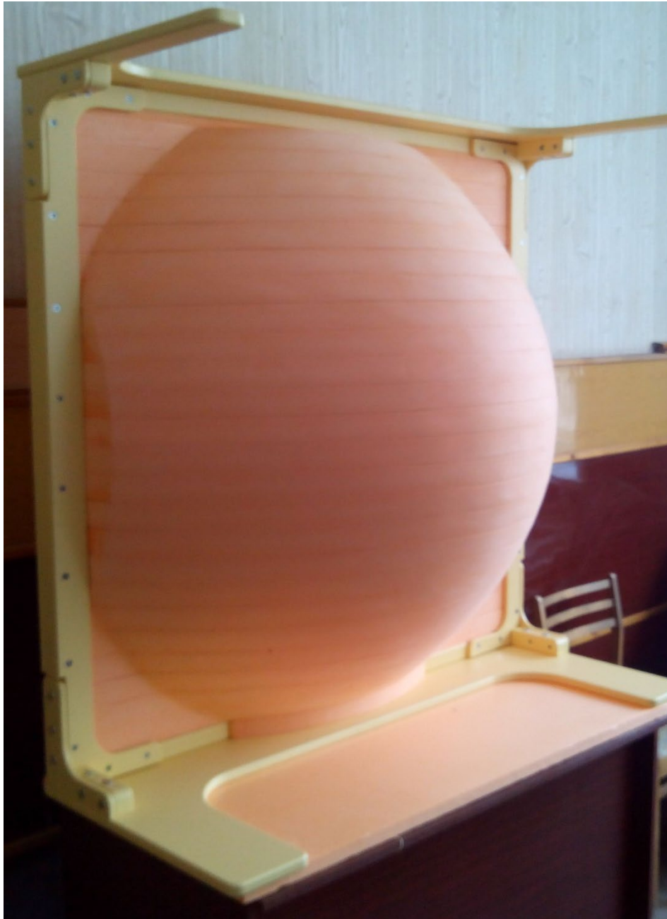
Рисунок 4.5 – Изготовленная радиолинза диаметром 1.1 метра из экструдированного пенополистирола
