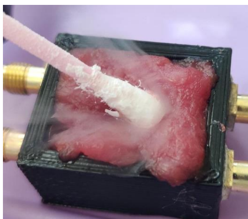
Рисунок 4.15 – Точечное охлаждение мышечной ткани с помощью аппликатора
