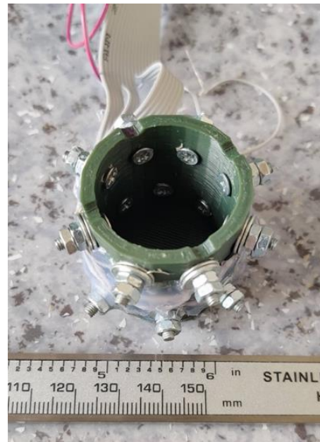
Рисунок 3.2 – Установка по исследованию процесса заморозки и нагрева исследуемых образцов биологической ткани
