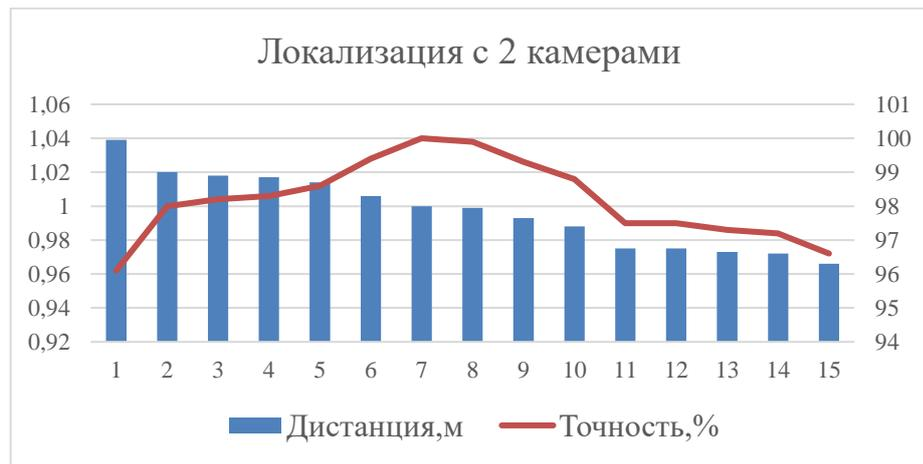
Рисунок 4.13 – Результаты измерений при локализации с двумя камерами глубины
