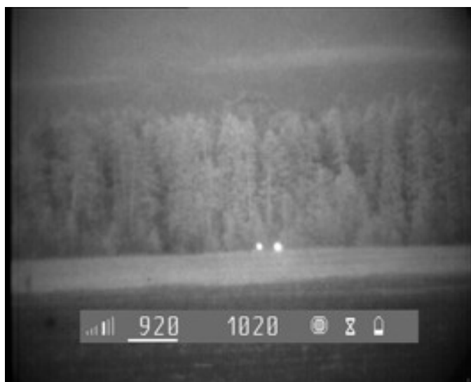
Рисунок 13 – Изображение в окуляре лазерного локаатора "Призрак-М" серии ТЛС 2000. Наблюдаемые цели: бинокль БПО 8x40 на дистанции 930 м (левый блик) и прицел ПСО-1 на дистанции 950 м (правый блик)
