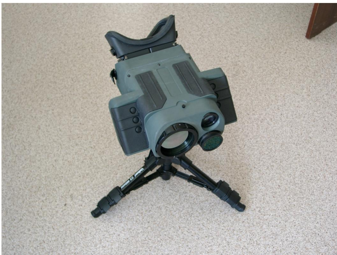
Рисунок 23 – Макетный образец МОЭП с тепловизионным и лазерным локационным каналами
