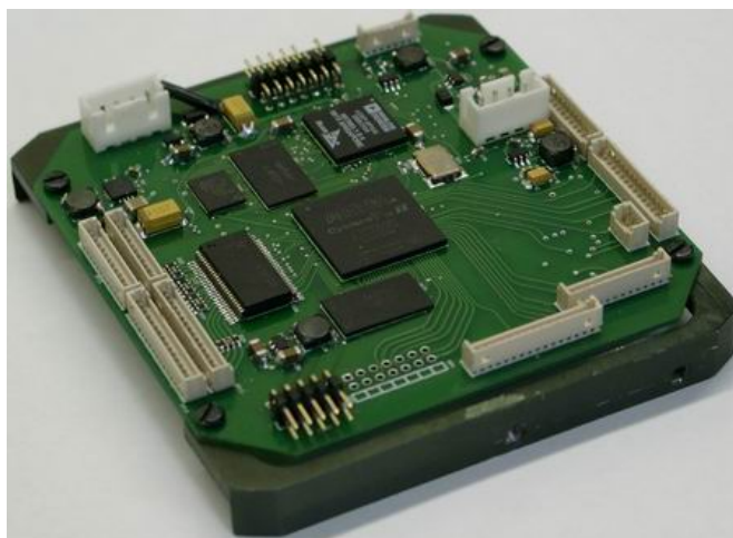
Рисунок 33 – Процессор изображений Журова Г.Е., разработанный на парадигме HPRC
