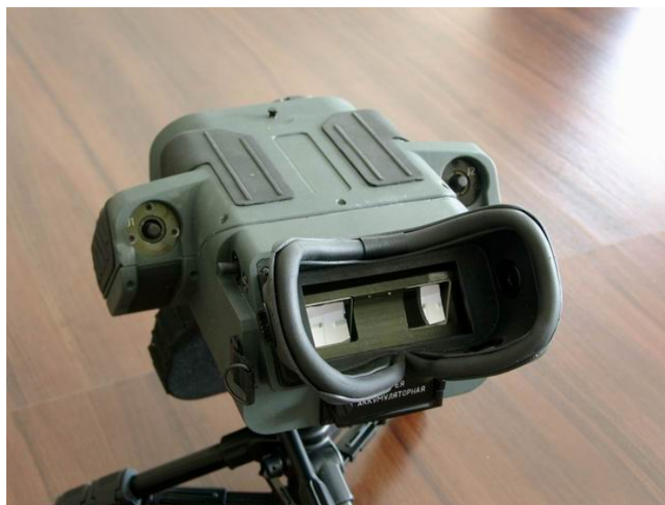
Рисунок 36 – Псевдобинокулярный микромонитор макетного образца МОЭП
