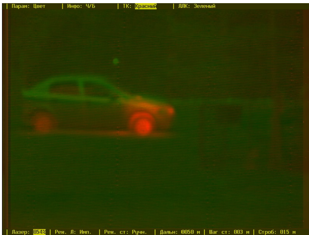
Рисунок 38 – Пример совмещенного изображения: автомобиль и отклик оптического прибора над автомобилем
