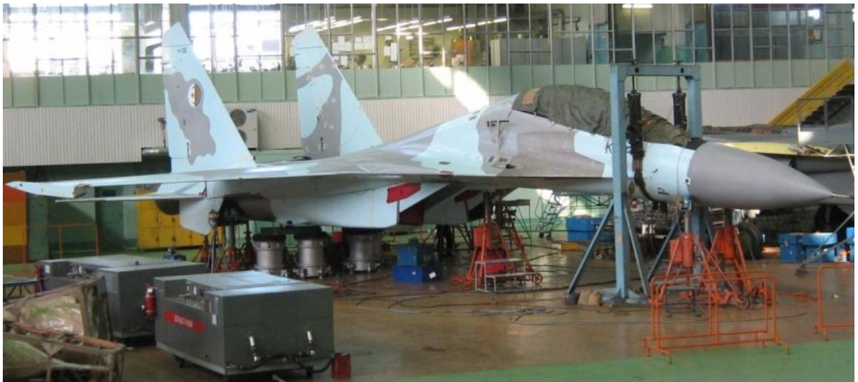
Рисунок 2.6 — Модальные испытания самолёта Су-30
