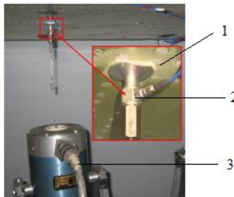
1 — панель; 2 — датчик силы; 3 — ЭДСВ
