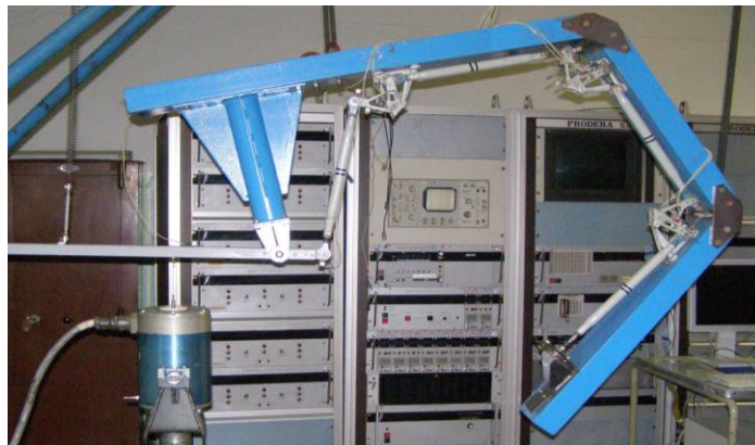
Рисунок 3.1 — Стенд для испытаний проводки управления
