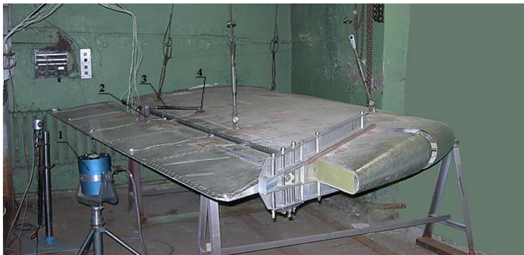
1 — ЭДСВ; 2 — кронштейн РВ; 3 — тяга; 4 — кронштейн стабилизатора
