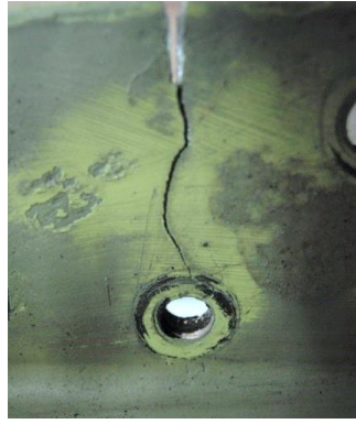
Рисунок 4.49 — Трещина в поясе нервюры
