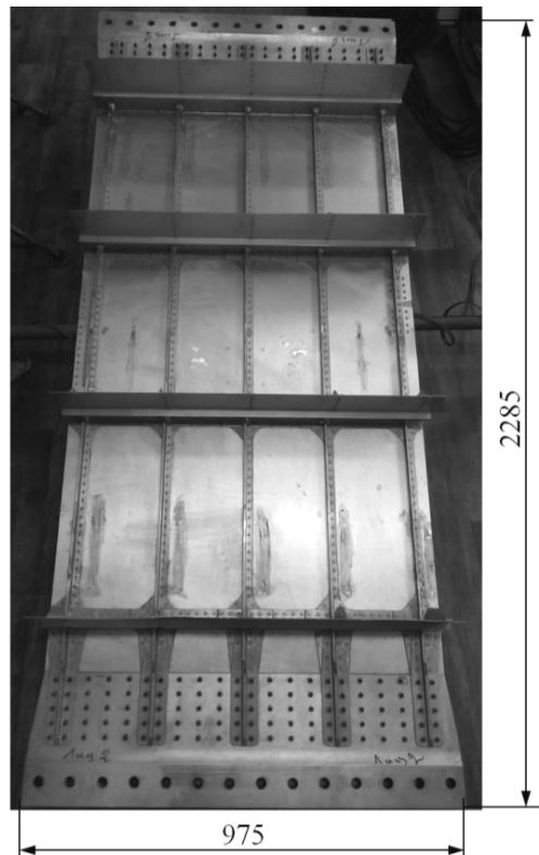
Рисунок 4.1 — Внешний вид и габаритные размеры панели фюзеляжа
