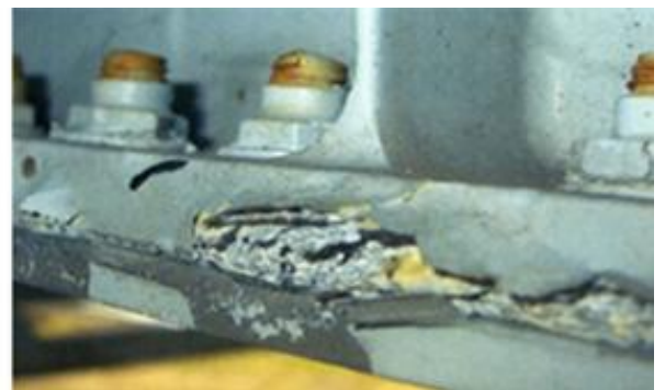
Коррозия кромки нижней полки лонжерона ОЧК крыла
