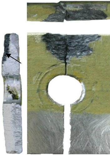
Рисунок 4.12 — Источник разрушения — язва
