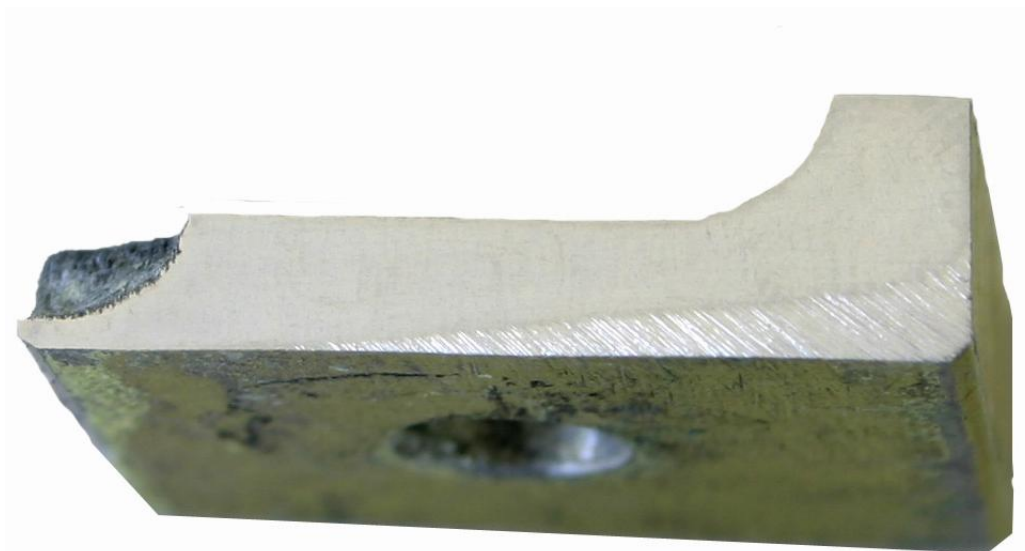
Рисунок 3.33 — Вид в сечении кромочной язвы полки лонжерона
