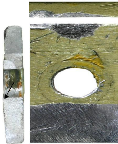
Рисунок 4.15 — Источник разрушения — отверстие
