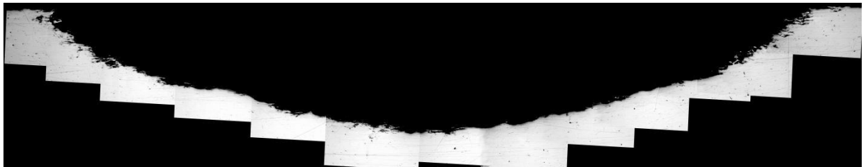
Рисунок 3.30 — Поперечное по размаху лонжерона сечение образца, вырезанного из стенки лонжерона, с типовой поверхностной язвой
