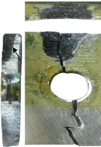
Рисунок 4.14 — Источник разрушения — язва
