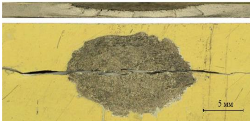
Рисунок 2.22 — Типичная множественность очагов усталостного разрушения на корродированной поверхности
