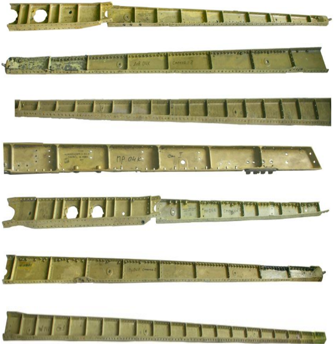
Рисунок 2.9 — Лонжероны ОЧК перед вырезкой образцов — полки с отверстиями и полосы для моделирования коррозионных повреждений и усталостных испытаний. Сплав В95пчТ2, штамповка
