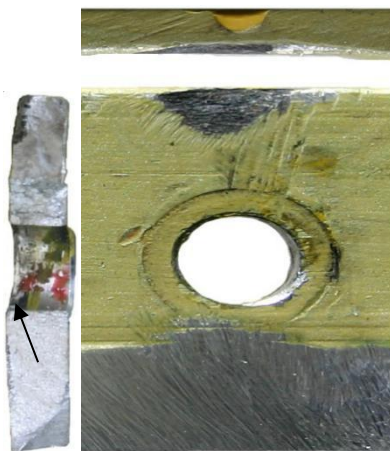
Рисунок 4.16 — Источник разрушения — отверстие
