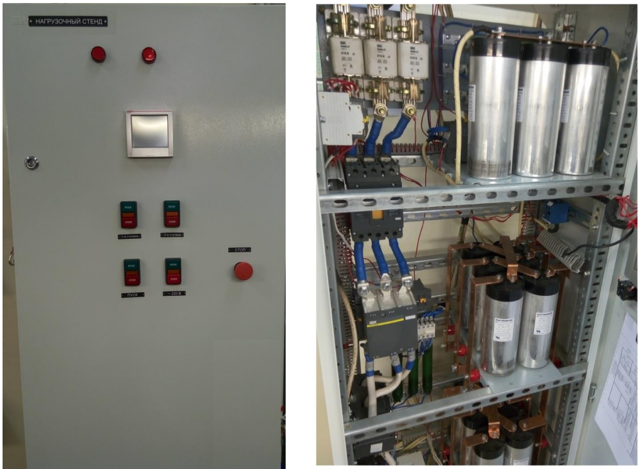
Рисунок 4.23 – Нагрузочный стенд, имитирующий режимы работы метрополитена
