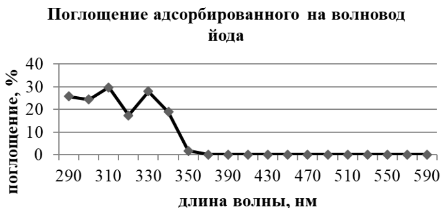
Рисунок 4.1 – Спектр поглощения волновода с адсорбированными парами йода [112]
