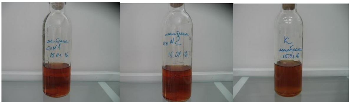
Рисунок 3.58 – Посев в тиогликолевой среде ТМ из ПЭТФ: а – образцы после обработки плазмой 30с; б – образцы после обработки плазмой 60с; в – образцы без плазменной обработки
