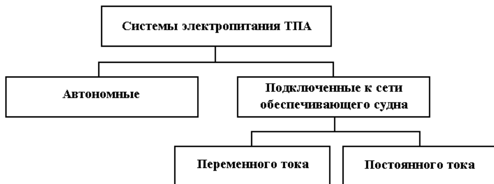
Рисунок 1.4 – Классификация систем электропитания телеуправляемых необитаемых подводных аппаратов
