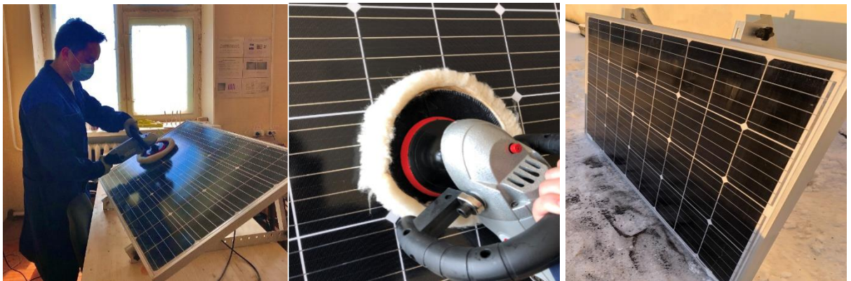
Рисунок 3.39 – Процедура нанесения покрытия на поверхность фотоэлектрической панели
