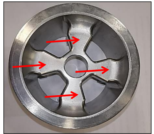
Рисунок 5.5 – Чертеж (а), модель (б) и снимок (в) кожуха клапана телеметрической системы. Стрелками указана упрочняемая поверхность (в)
