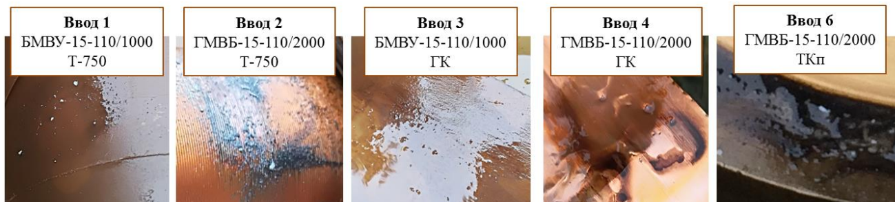
Рисунок 6 - Внешний вид отложений на различных частях высоковольтных вводов с БМИ напряжением 110-220 кВ
