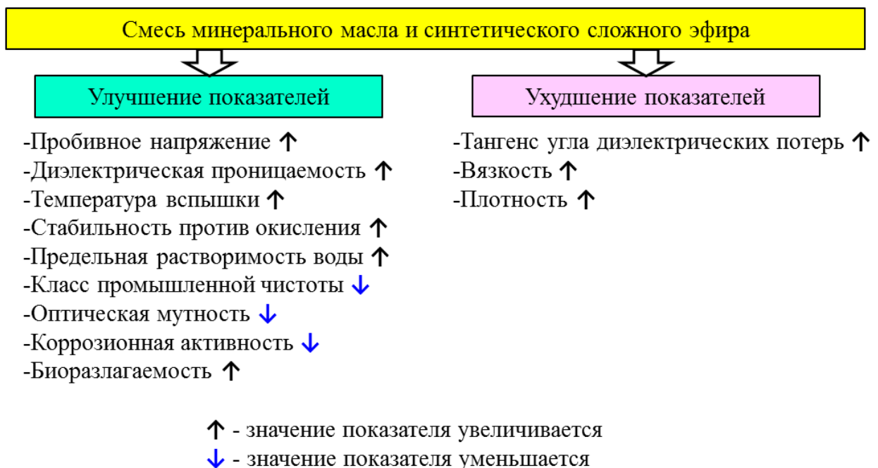
Рисунок 7 – Изменение характеристик минерального масла при добавлении синтетического сложного эфира
