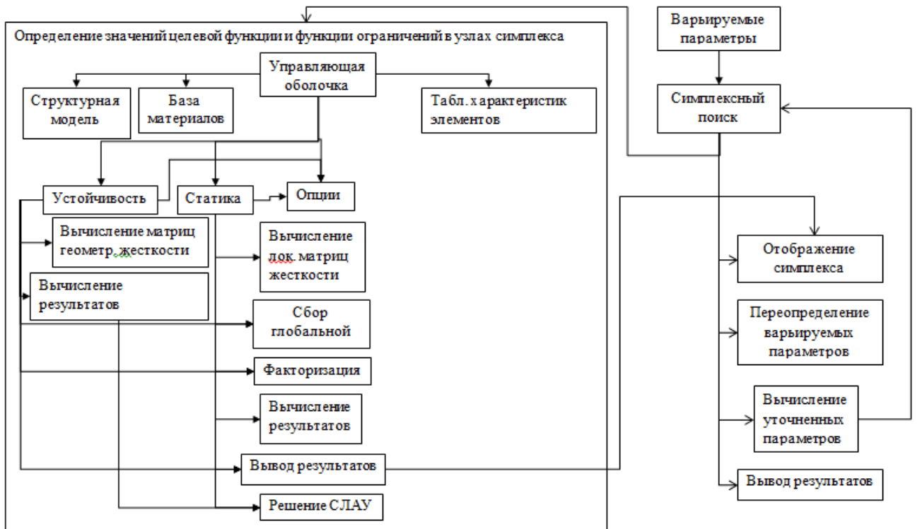
Рисунок 3 – Схема ПП «Композит НК Анизогрид» после внедрения модуля
