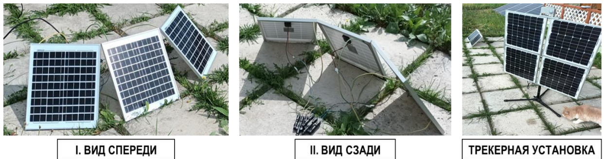
Рисунок 4 – Дугообразное размещение фотоэлектрических панелей и трекер
