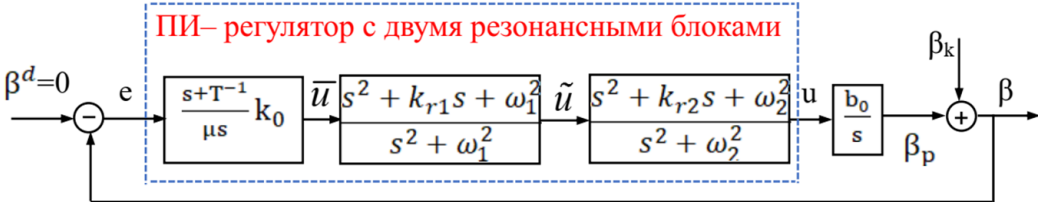
Рисунок 7- Структурная схема для стабилизированной платформы с ПИ-регулятором с двумя резонансными блоками
