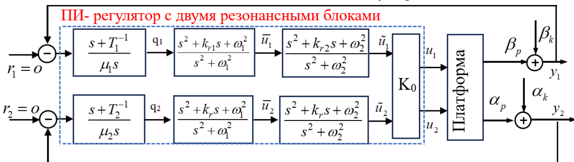
Рисунок 18 - Структурная схема двухканальной стабилизированной платформы с двумя резонансными блоками в каждом канале
