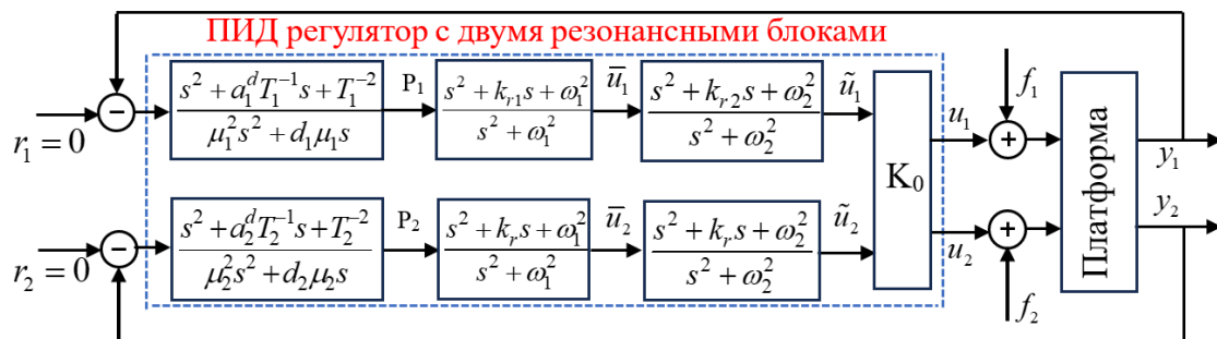
Рисунок 29 - Структура системы управления для двухканальной стабилизированной платформы с двумя резонансными блоками
