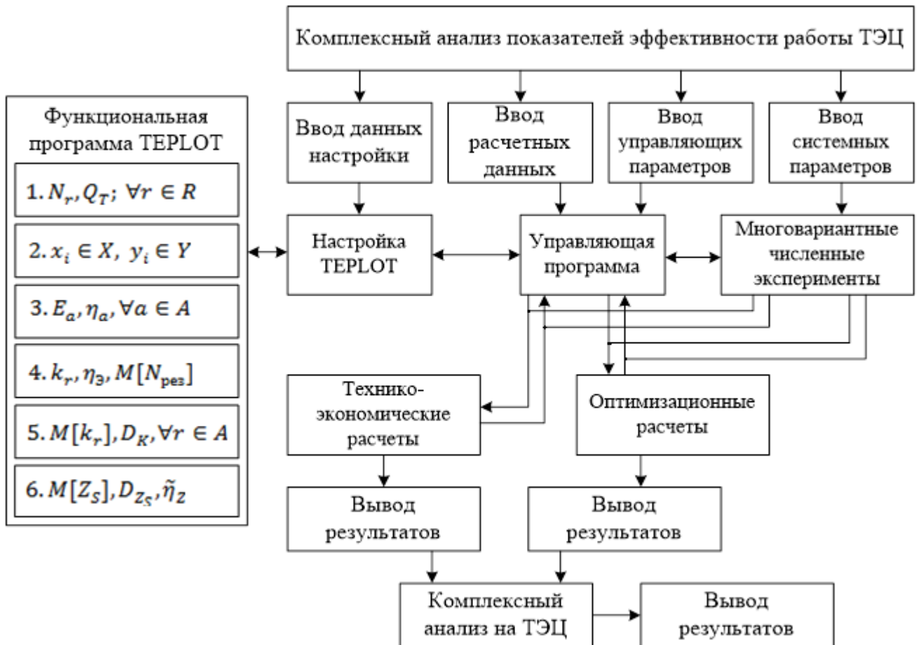
Рисунок 2 – Структурная схема вычислительного комплекса ОРТЭС.
