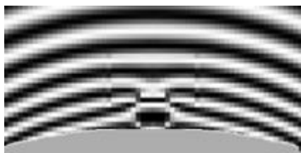
Рисунок 3.12. — Деформация керрограммы при внесении вблизи острия пузырька d = 20 мкм для набора напряжений, прикладываемых к электродам
