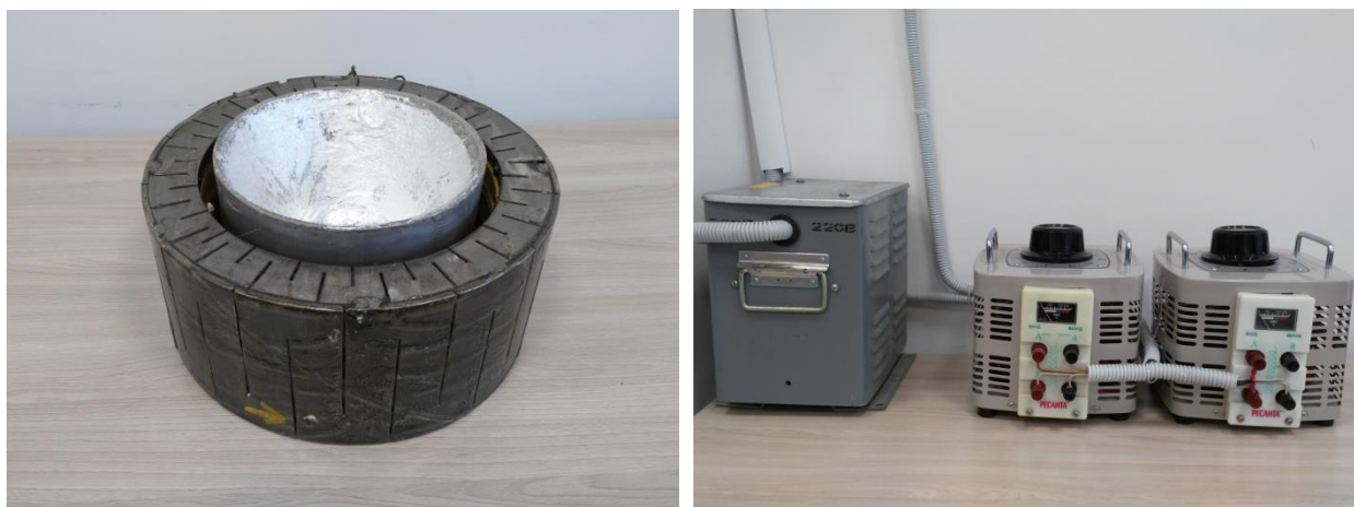
Рисунок 4.2 – Общий вид экспериментальной установки (а) и лабораторные автотрансформаторы (б)
