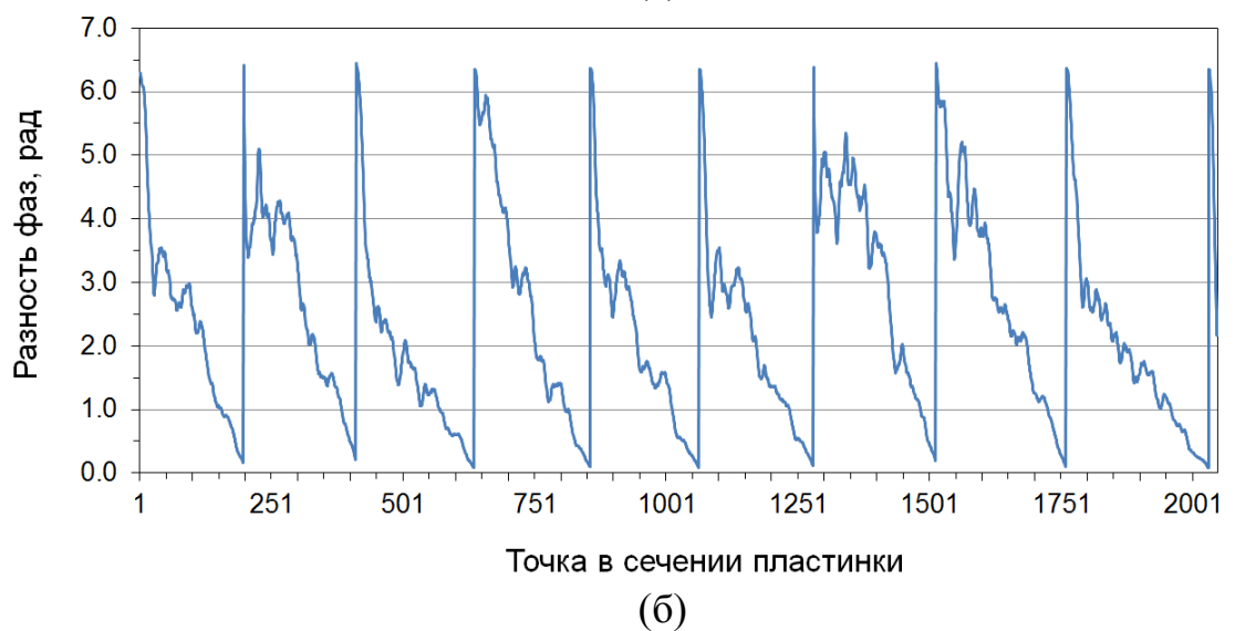
Рисунок 4 – Разность фаз по центральному сечению (а) и после обработки предложенным фильтром Калмана (б).
