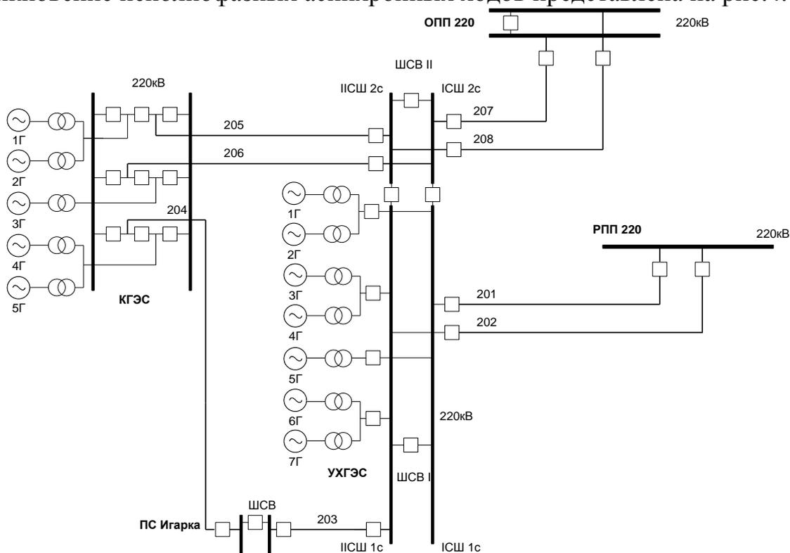
Рис. 4. Структурная схема сети 220 кВ объединенной Таймырской и Норильской энергосистемы
