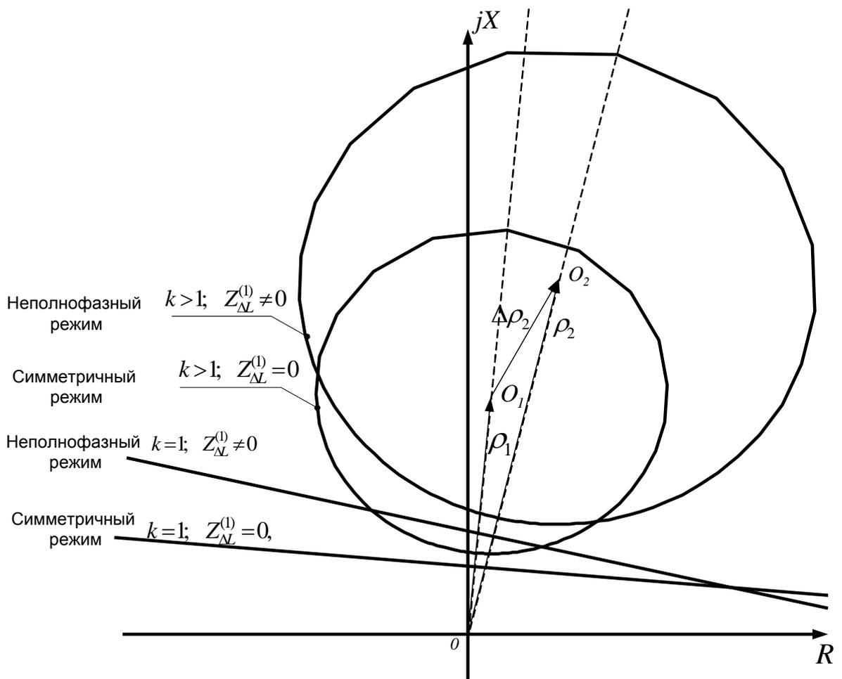
Рис. 1. Годограф  $Z_1 = f(\delta)$  при симметричном и несимметричном АР
