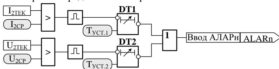
Рис. 10. Блок-схема алгоритма адаптации к неполнофазному режиму.
