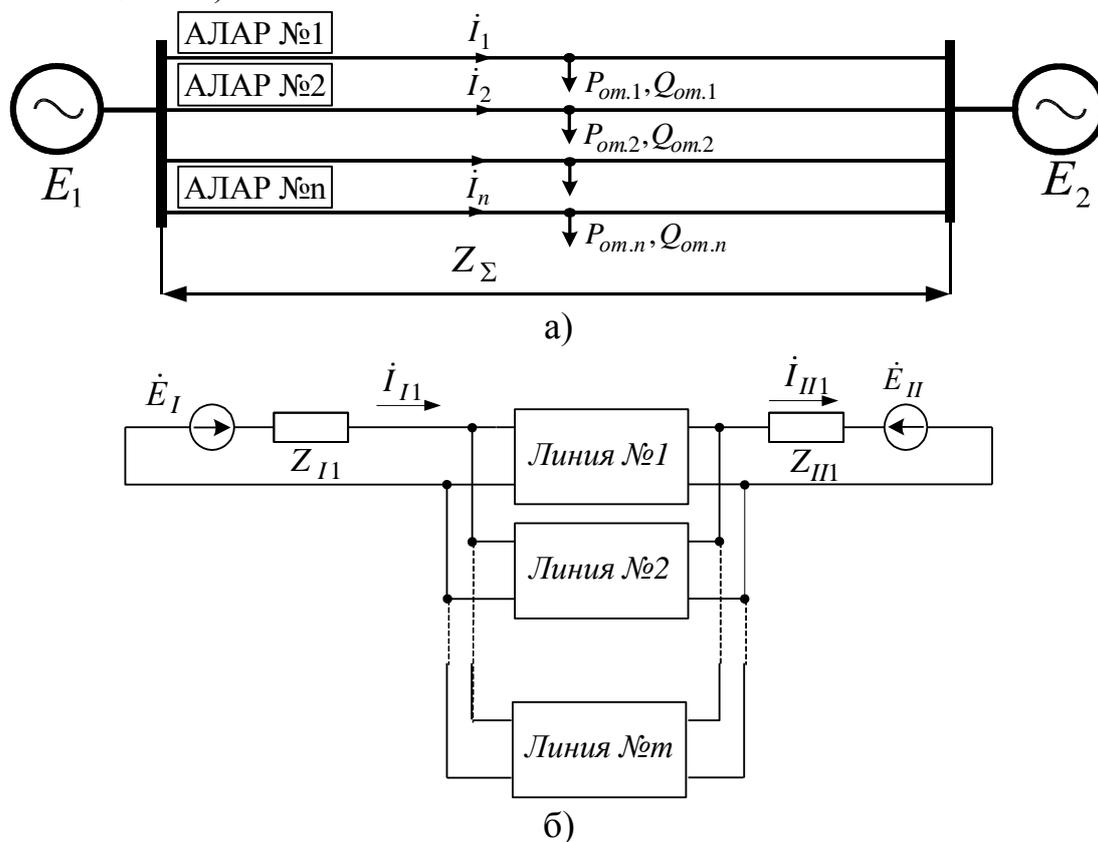
Рис. 3. Расчетная схема (а) и схема замещения (б)
