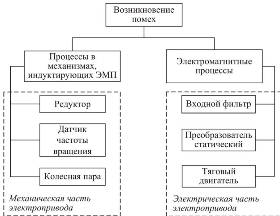
Рис. 3. Источники помех в тяговом электроприводе
